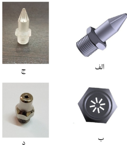
شکل ۲- طرح سه بعدی نازل جت چندگانه (نمای جانبی الف) و سطح مقطع شکاف‌ها (ب)، نازل جت چندگانه ساخته شده (ج)، نازل مرسوم تفنگ‌های باد پاش (د)
