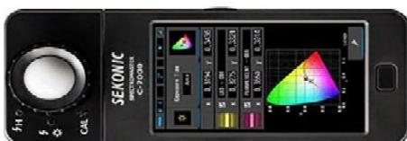
شکل ۲. دستگاه اسپکترورادیومتر SEKONIC-7000
