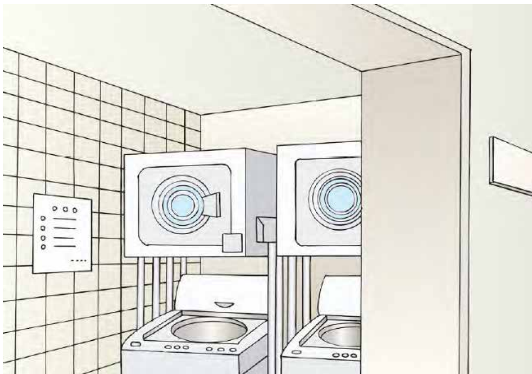
شکل ۳۱-۱: ماشین های پر سروصدا را جابه جا کنید تا از مکانی که کار مراقبت در آن انجام می شود فاصله داشته باشند.
