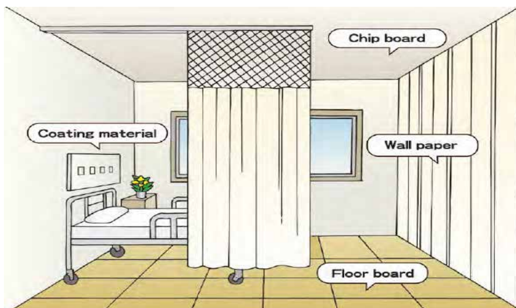
شکل ۳۶-۱: مطمئن شوید مواد ساختمانی که ممکن است در آنها مواد شیمیایی خطرناک مانند فرمالدئید، گزین و سایر ترکیبات بکار رفته باشد به طرز صحیح استفاده و نگهداری می شود.
