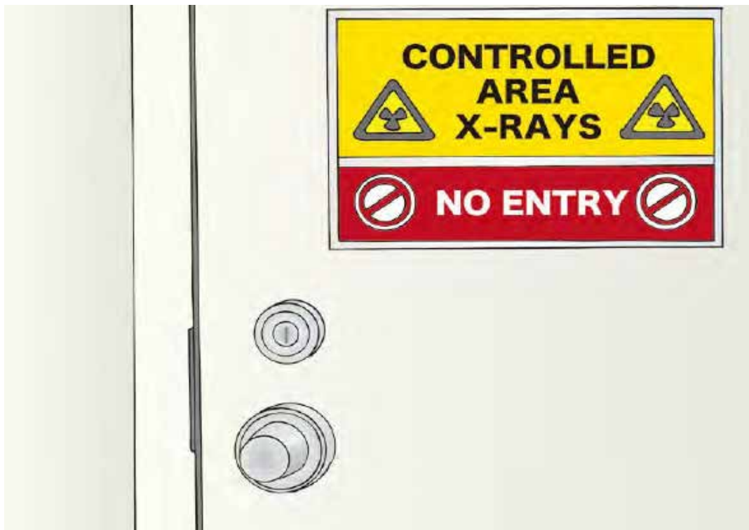
شکل ۳۴-۱: از علائم هشداردهنده با ارجاع به استانداردهای بین المللی برای کنترل نواحی رادیو اکتیو استفاده کنید.
