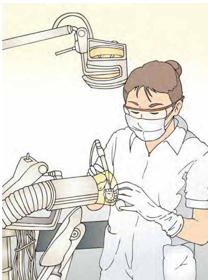
شکل ۳۶-۲: استفاده از تهویه موضعی برای کنترل گرد و غبار خطرناک ناشی از مواد دندانانی در یک کلینیک دندانپزشکی.
