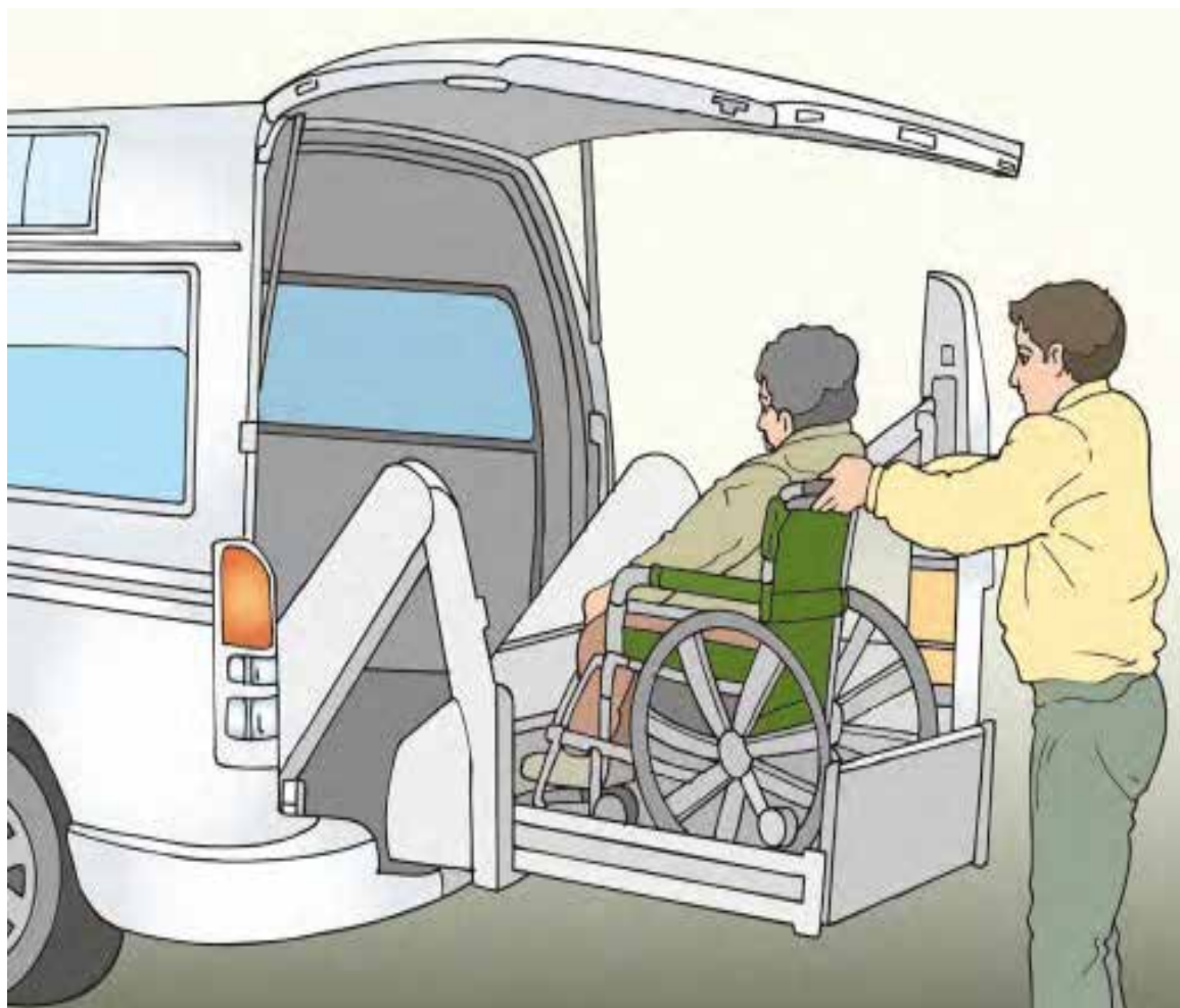
شکل ۱۸: بالابر ویلچر وسیله نقلیه را طبق توصیه سازنده سرویس کنید. برنامه نگهداری را در دفترچه ثبت وسیله نقلیه یادداشت کنید.
